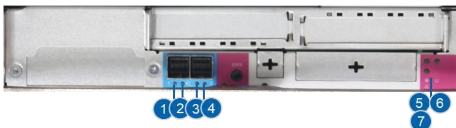
Рисунок 3-18 светодиодов модуля IO устройств 2U и 3U
