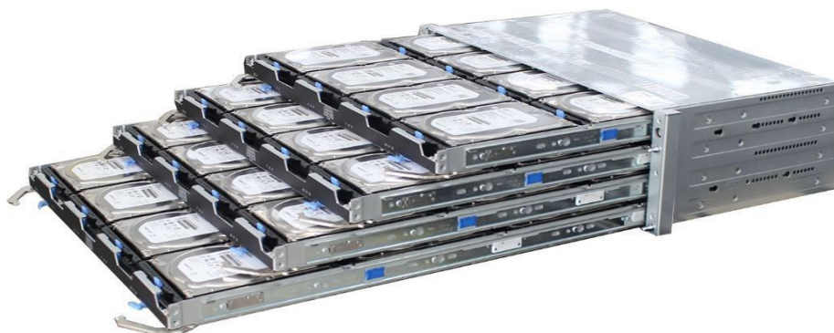
Рисунок 2-18 Структура модуля жесткого диска 3U
