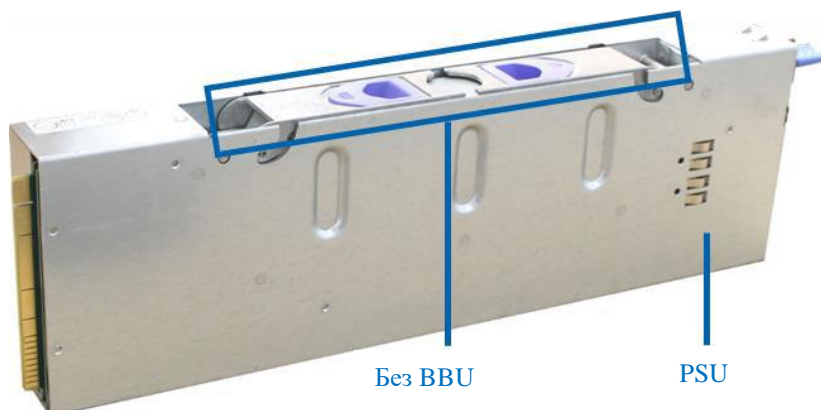
Рисунок 2-28 PSU дискового модуля 3U
