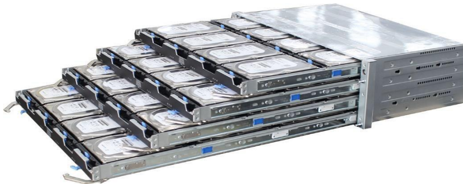
рисунок 2-4 структура дискового модуля 3U
