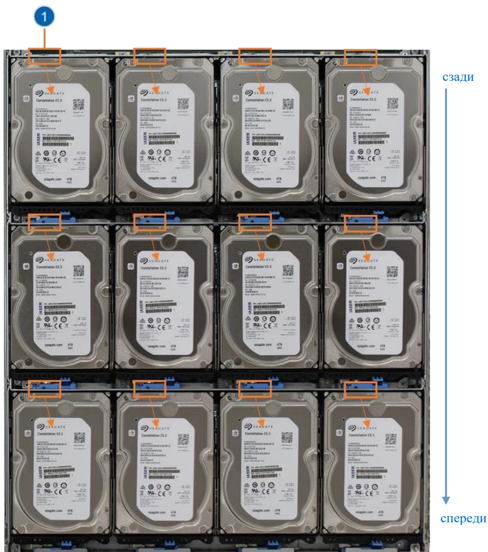
Рисунок 3-4 Светодиодные индикаторы дисковых модулей жестких дисков в корпусе 3U
